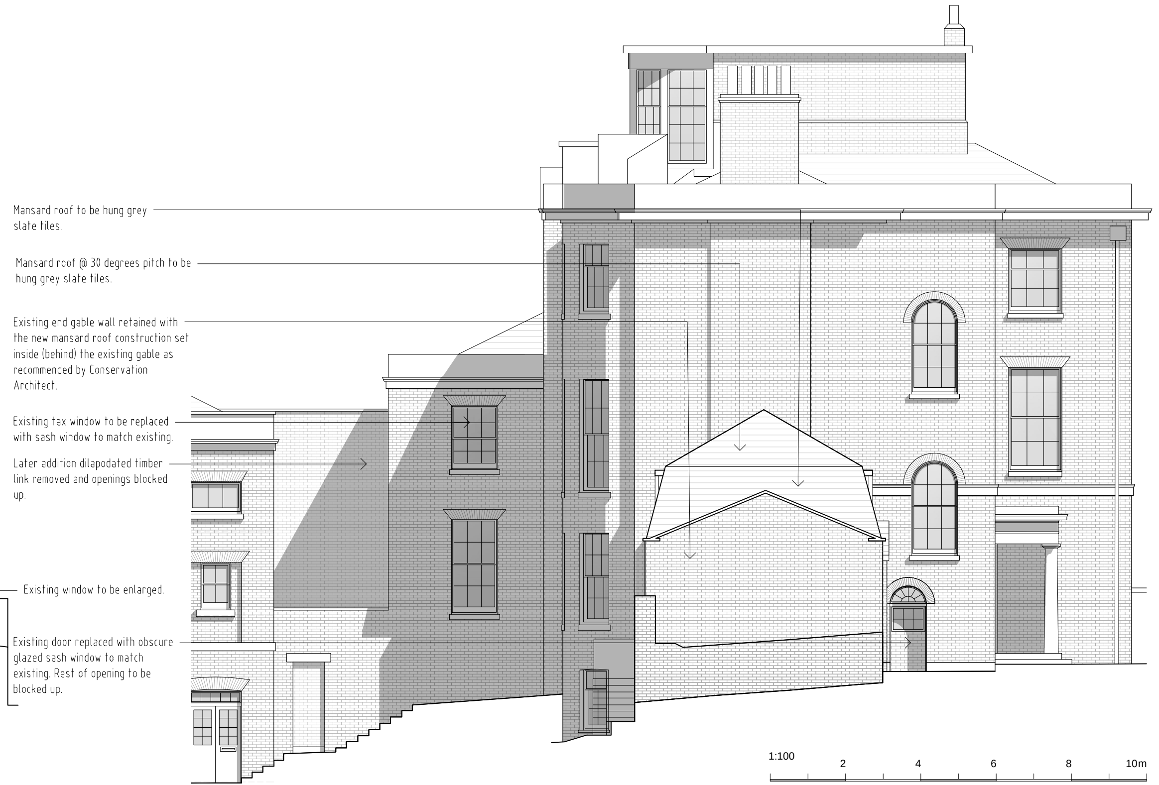
Left flank elevation
